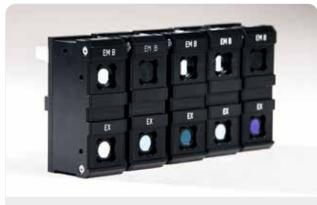
Fully-equipped assay-specific Optic Modules.
